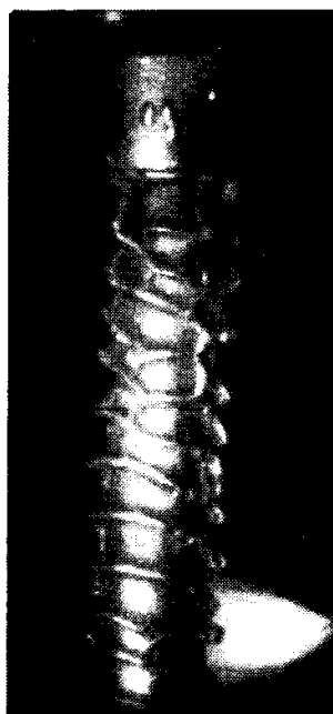
Рис. 111. Искажение цилиндрической формы струи стереорегулярного каучука при высоких напряжениях сдвига.
